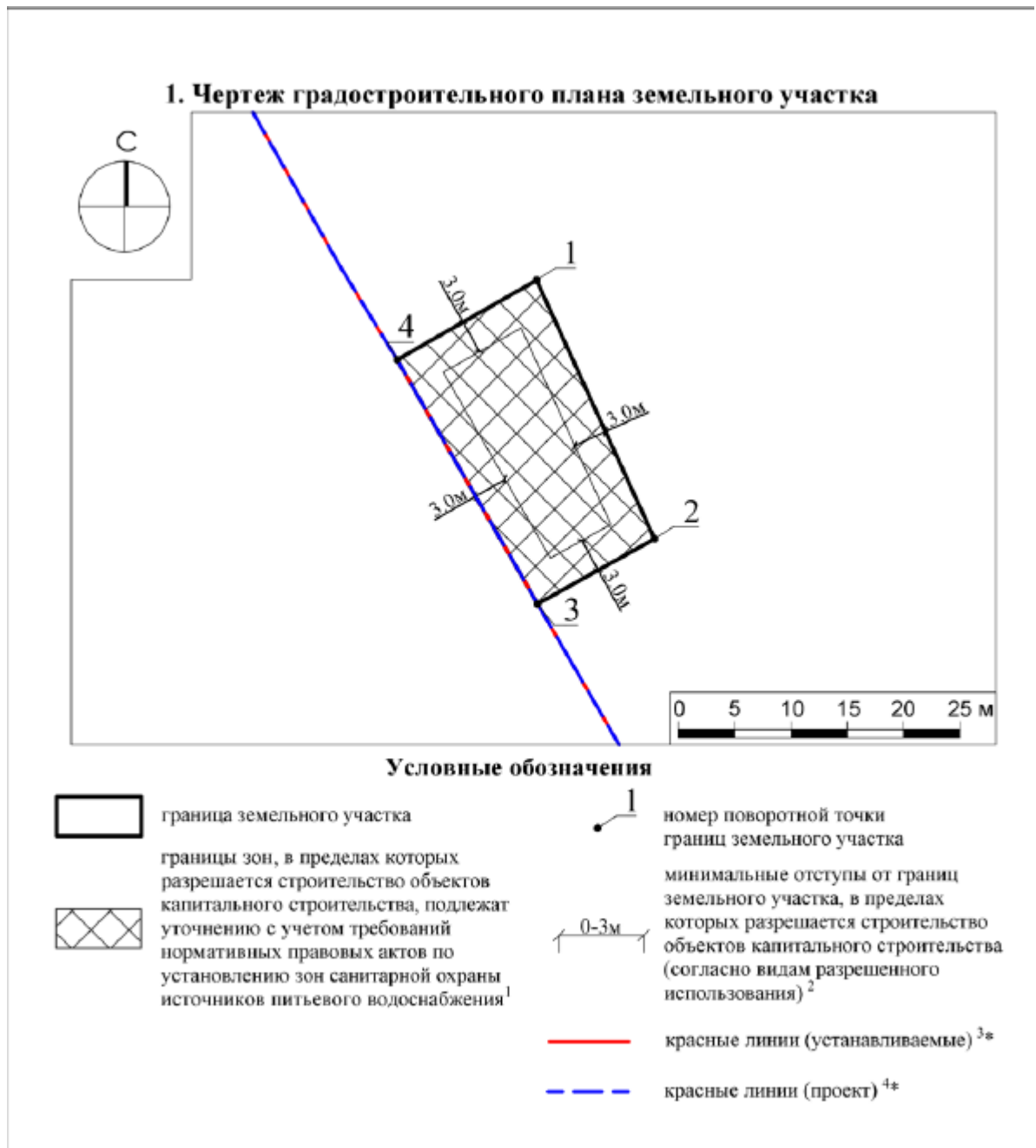
Рисунок 2 – Чертеж градостроительного плана земельного участка
